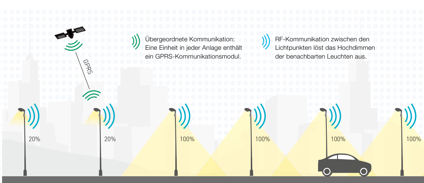
Bild 1: Der Radar erfasst die sich nähernden Fahrzeuge (bis zu einer Geschwindigkeit von 200 km/h) und kommuniziert den benachbarten Leuchten, die Lichtintensität zu erhöhen. Die Anzahl der aktivierten Leuchten und die Dauer der Aktivierung sind einstellbar.
